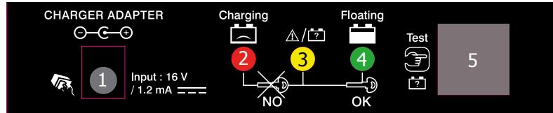
**1** 机适配器插孔，仅限使用随机提供的适配器
