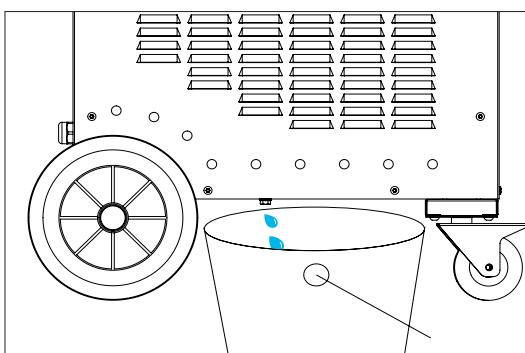
9. Per evacuare il liquido rimanente nel fondo del serbatoio, utilizzare una pompa a depressione o inclinare il dispositivo sulla parte anteriore.
