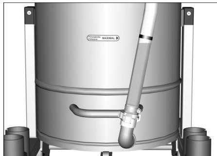
**Anmärkning:** Den röda markeringen på avtappningsslängen visar den maximalt tillåtna nivån.
