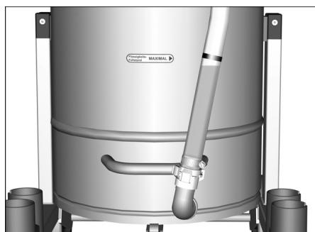
**Указание:** Червената маркировка на изпускателния маркуч показва максимално допустимото ниво на запълване.
