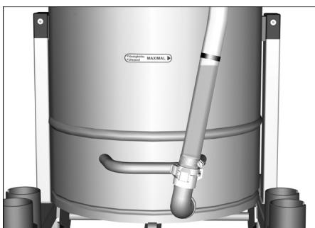
**Merknad:** Den røde markeringen på tappe-slangen viser maksimal tillatt fyllingsnivå.
