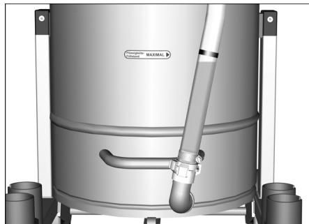
**Instructie:** De rode markering op de aftapslang geeft het maximale vulniveau weer.
