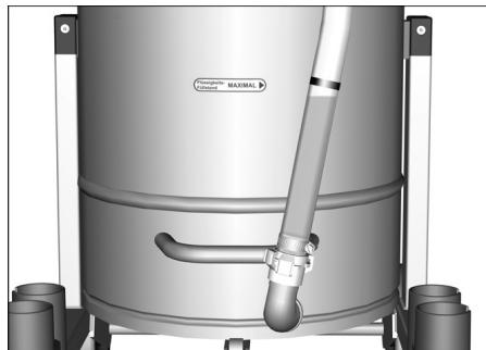
**Aviso:** A marcação vermelha na mangueira de escoamento indica o nível de enchimento máximo permitido.
