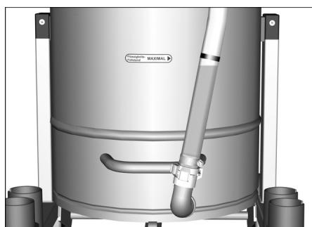
**Υπόδειξη:** Το κόκκινο σημάδι στον ελαστικό σωλήνα απορροής δείχνει τη μέγιστη επιτρεπόμενη στάθμη πλήρωσης.
