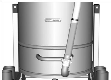
**Hinweis:** Die rote Markierung am Ablassschlauch zeigt den maximal zulässigen Füllstand an.
