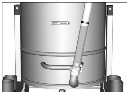
**Bemærk:** Den røde markering på aftapningsslangen viser det maks. tilladte påfyldningsniveau.
