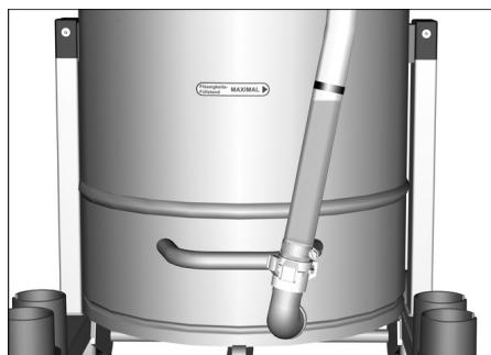
**Indicazione:** La marcatura rossa al tubo flessibile di scarico indica il livello massimo consentito di riempimento.
