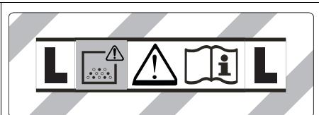
**ADVARSEL:** Maskinen inneholder helse-skadelig støv. Tømming og vedlikehold, inkludert fjerning av støvpose, skal kun utføres av sakkyndig personale som bruker egnet personlig verneutstyr. Ikke slå på før hele filtersystemet er installert.
