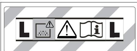
**ADVERTENCIA:** Este aparato contiene polvos nocivos para la salud. El vaciado y el mantenimiento, incluida la retirada de la bolsa de polvo, sólo lo puede realizar personal especializado que lleven un equipo de seguridad personal apropiado. No conectar antes de que el sistema de filtrado completo esté instalado.
