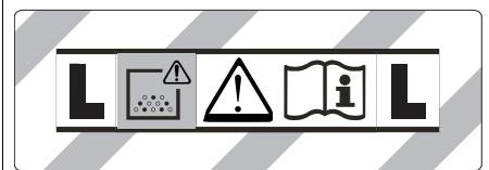
**ΠΡΟΕΙΔΟΠΟΙΗΣΗ:** Η συσκευή αυτή περιέχει σκόνη βλαβερή για την υγεία Η εκκένωση και η συντήρηση, συμπεριλαμβανομένης της αφαίρεσης της σακούλας σκόνης, πρέπει να εκτελούνται μόνο από ειδικούς, οι οποίοι χρησιμοποιούν κατάλληλο προσωπικό εξοπλισμό προστασίας. Να μην ενεργοποιηθεί, πριν εγκατασταθεί ολόκληρο το σύστημα φίλτραρισμάτος.
