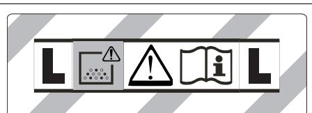
**UPOZORENJE:** Ovaj uređaj sadrži prašinu koja je štetna po zdravlje. Pražnjenje i održavanje uređaja, uključujući i uklanjanje vrećice s prašinom, smiju izvoditi samo stručne osobe s odgovarajućom osobnom zaštitnom opremom. Ne uključujte prije nego što se ugradи čitav sustav za filtriranje.
