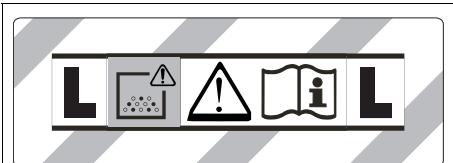
**WARNUNG:** Dieses Gerät enthält gesundheitsgefährliche Stäube. Entleerung und Wartung, einschließlich der Entfernung des Staubbeutels, dürfen nur von sachkundigen Personen vorgenommen werden, die geeignete persönliche Schutzausrüstung tragen. Nicht einschalten, bevor das komplette Filtersystem installiert ist.
