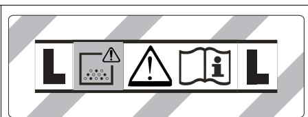
**ADVERTÊNCIA:** este aparelho contém pós nocivos para a saúde. O esvaziamento e manutenção, incluindo a eliminação do saco do pó, só podem ser realizados por pessoas qualificadas que utilizem equipamento de protecção pessoal adequado. Não ligar enquanto o completo sistema de filtração não estiver instalado.
