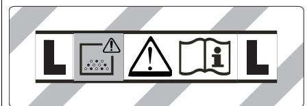
**ПРЕДУПРЕЖДЕНИЕ:** В данном устройстве находится опасная для здоровья пыль. Опорожнение и техническое обслуживание, в том числе, удаление пылесборного мешка, должно проводится только специалистами, носящими подходящее защитное снаряжение. Не включать до полной установки фильтровальной системы.
