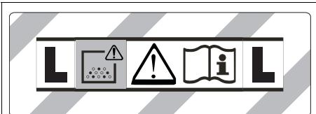
**OPOZORILO:** Ta naprava vsebuje vrste prahu, ki so zdravju nevarne. Praznjenje in vzdrževanje, vključno z odstranjevanjem vrečke za prah, smejo izvajati le strokovne osebe, ki nosijo ustrezno osebno zaščitno opremo. Ne vklopite, preden ni instaliran celoten filtrski sistem.
