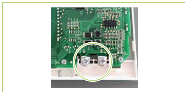
Abb. 9: Kontakte HA und HB der Fernbedienung
